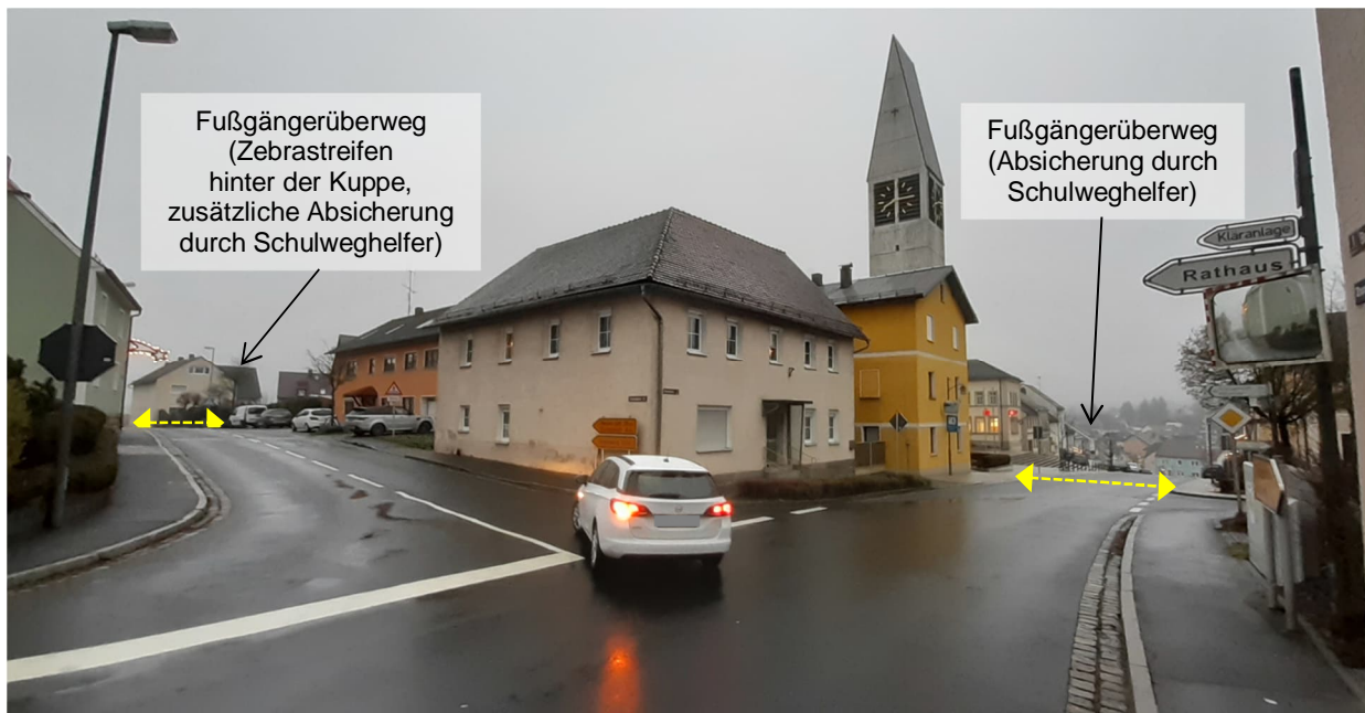
Bild 21: Übereckverbindung der St 2120 in der Ortsdurchfahrt; vorhandene Fußgängerquerungen
