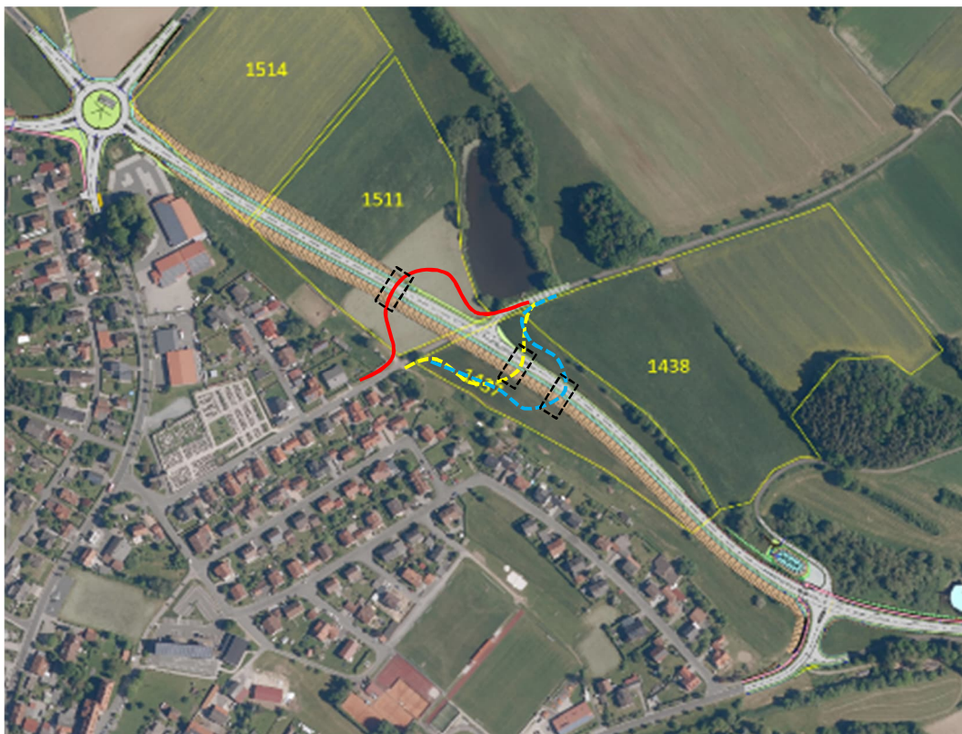
Bild 32: GRW-Variante V3.8A: verschiedene Trassierungsmöglichkeiten
