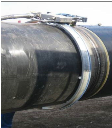
Abbildung 20 Prüfen der Schweißnähte mittels Ultraschall- / Durchstrahlungsprüfung
